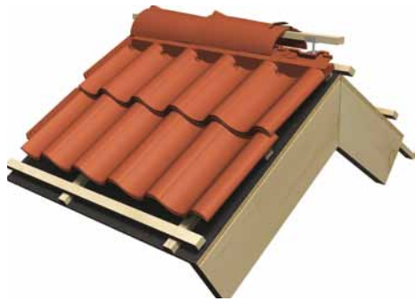
Bild 9. Vid användning av nockanslutningspanna rekommenderar vi att börja läktningen från toppan, se tabell 4 och 6.
