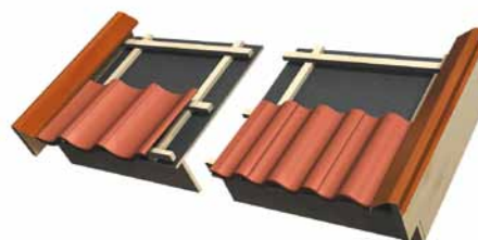
Bild 6. Byggbredd för Hansa är ca 211 mm och för Tvilling 344 mm. Tänk på att vindskiveplåten ligger över pannorna, så att vattnet leds ner i pannans dal. Byggbredd för Piano är ca 204 mm.
