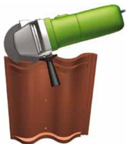
Bild 12. Det är viktigt att slipa bort lite av undersidan på takpannan, så att takpannan inte blir liggande ovanpå taktillbehören.
