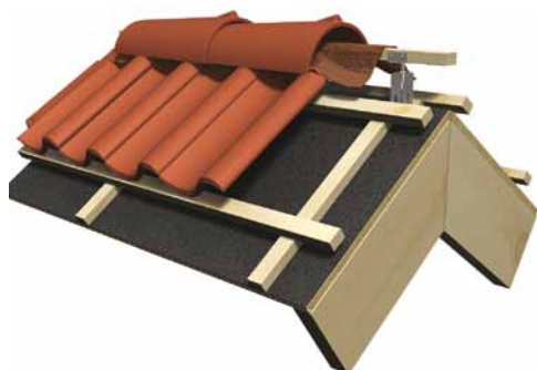
Bild 10. Det är viktigt att nock- och valmtättningsrullen inte ligger mot sidorna på nockplankan, utan endast i ovankant. Då luftas nockplankan ordentligt. Se tabell 5 och 7.
