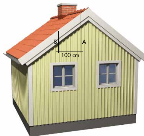
Bild 1. Mått A minus mått B ger underlag för bestämning av husets taklutning
